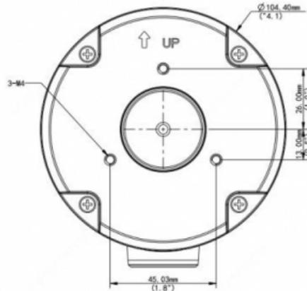
BALTER X Kleine Anschlussdose / Mini Junction Box für Außenkameras mit Fixbrennweite - BCC-A16JB
