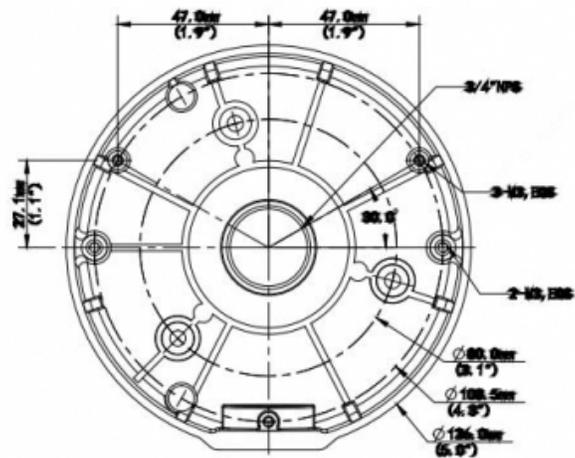
BALTER X Anschlussdose / Junction Box für Eyeball- Mini-PTZ- und Dome-Kameras mit VF-/Motorzoom-Objektiven, D126 x 36 mm, Aluminium, Weiß - BCC-A12JB
